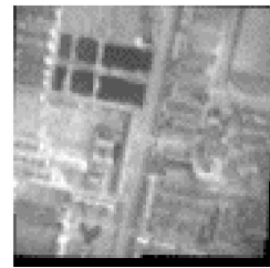
(d) 采用基于控制点几何纠正处理地面分辨率为 5m 图像
